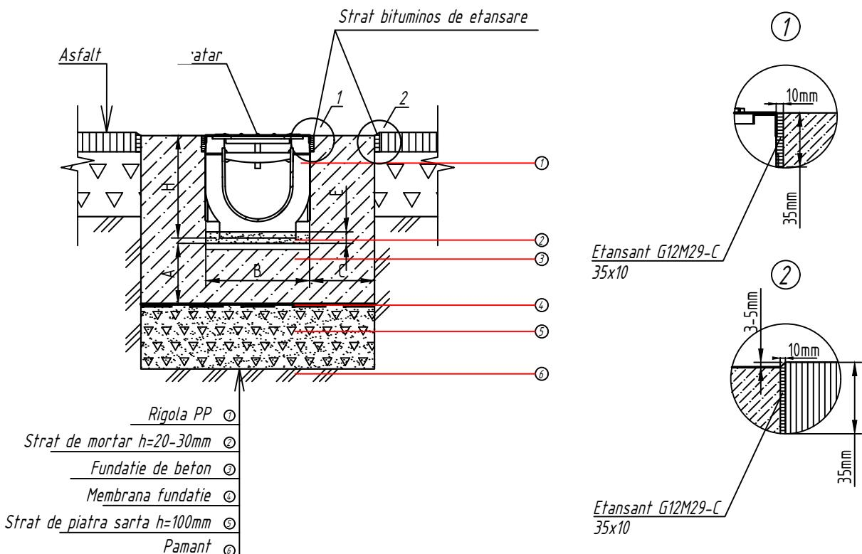
*Parametrii recomandati pentru invelisul din beton*
